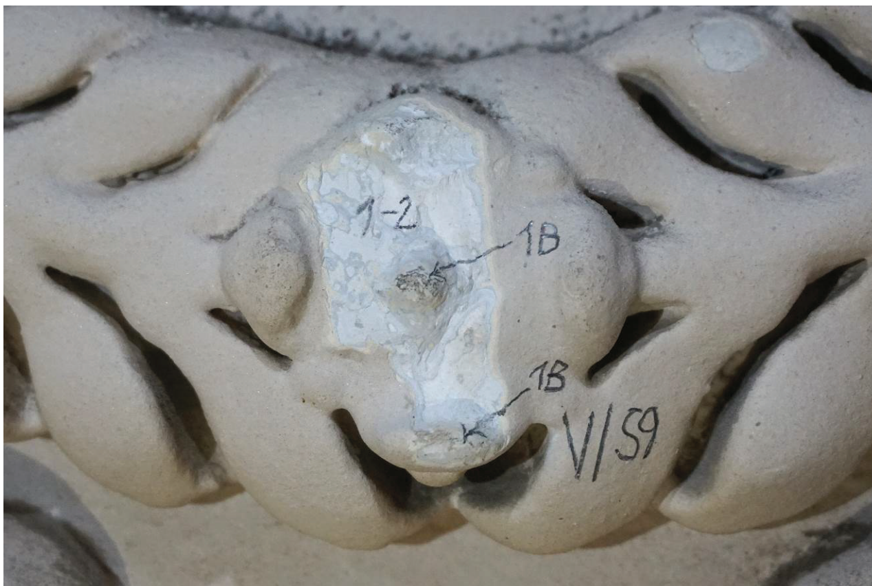
Obr. 12. Sonda V/S9 na rostlinném věnci. 1: Nejstarší dochovaná barevná vrstva béžovo-šedá. 1b: Fragmenty barevných okrovo-černých akcentů ve vrcholu plasticity. 2: Vápenný nátěr šedý.
